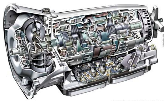
Automatisches Getriebe W7A700 (BM 722.9)
